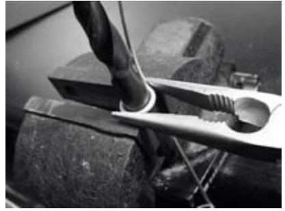
Figure 4.18: Courber le fil autour de la perceuse pour faire une boucle.
