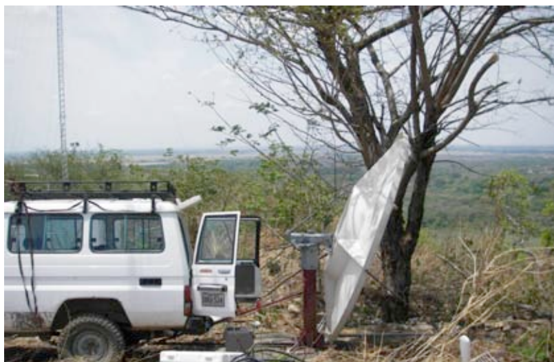
Figure 11.34: Installation d'antenne à El Bau. L'altitude réelle était de 1° vers le haut car l'antenne avait un décalage de 22,5°.
