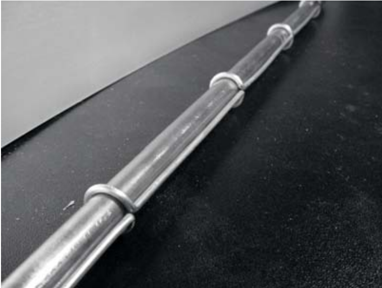
Figure 4.21: L'insertion d'un tuyau peut aider à redresser le fil.
