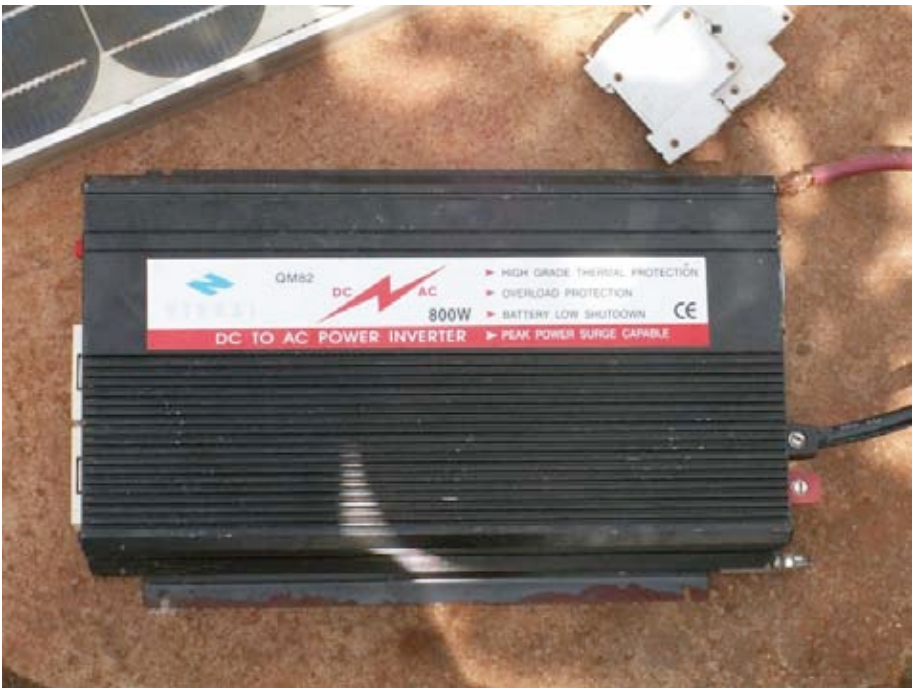
Figure 7.4 : Un convertisseur DC/AC à 800 Watt.
