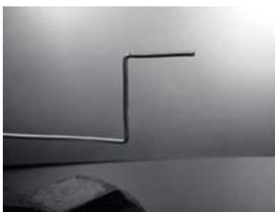
Figure 4.17: Plier le fil en forme de « Z ».
