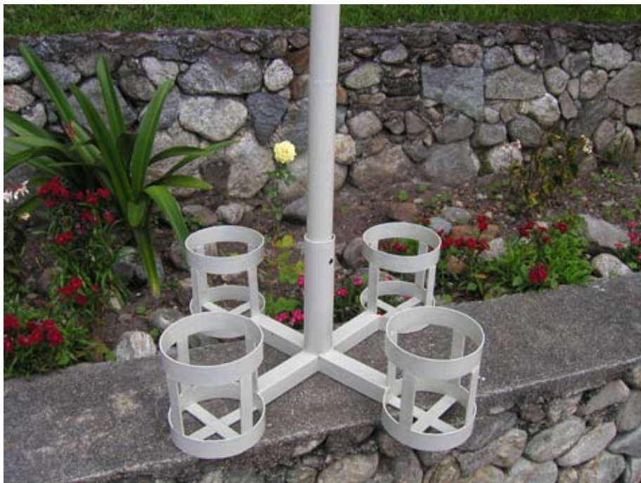
Figure 8.5 : Cette base en métal peut être soutenue par des sacs de sable, des pierres, ou des bouteilles d'eau pour créer une plateforme stable sans perforer le toit.
