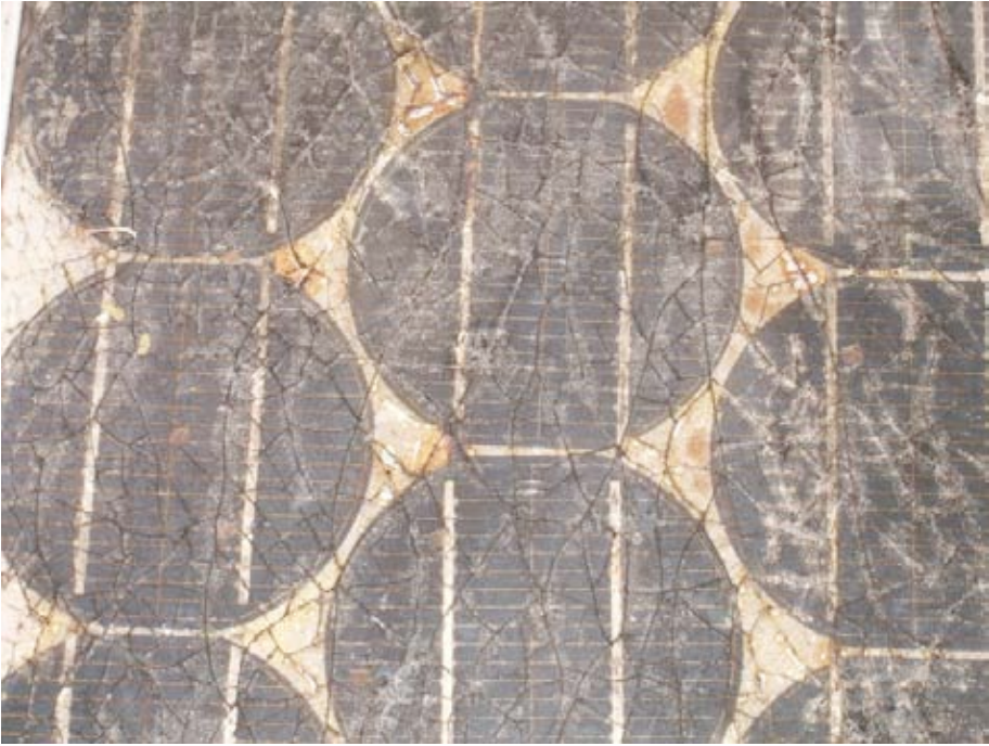
Figure 7.6 : L'effet de l'eau et la corrosion sur un panneau solaire.
