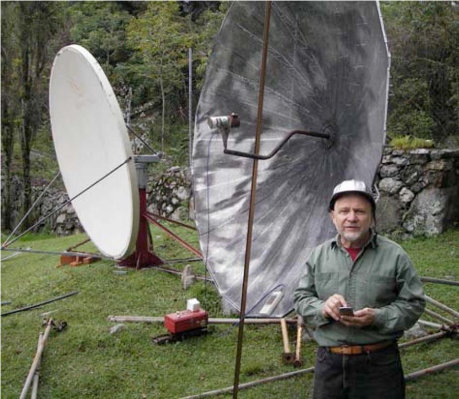
Figure 11.31: Trouver le focus de l'antenne avec une alimentation de 2,4 GHz
