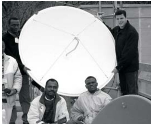
Figure 4.11: Un réflecteur d'antenne parabolique solide.
