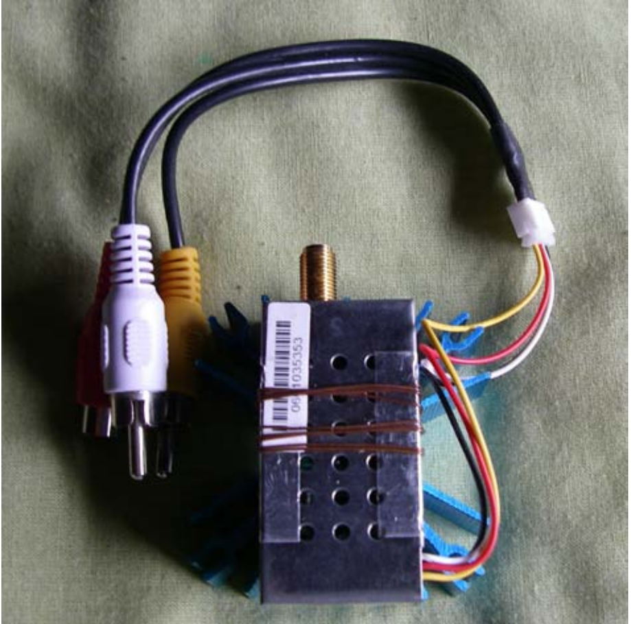
Figure 8.7 : Un expéditeur vidéo a 2.4 GHz avec un connecteur d'antenne SMA
