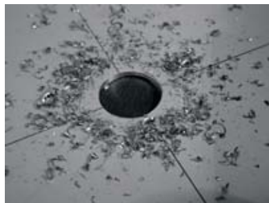
Figure 4.22: Percer un trou dans la plaque métallique.
