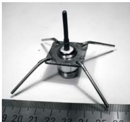
Figure 4.8: Antenne ground-plane d'un quart de longueur d'onde.
