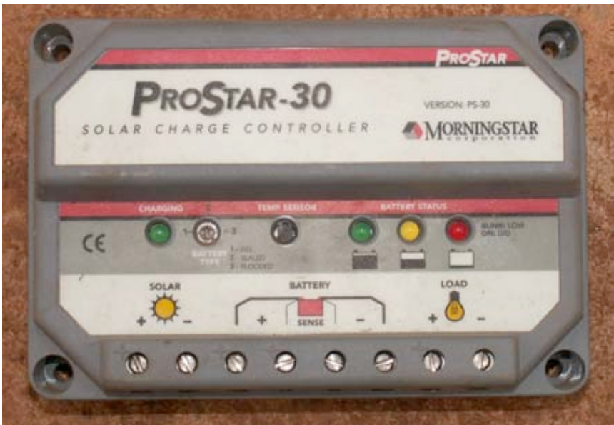
Figure 7.3 : Un contrôleur de charge solaire de 30 A.
