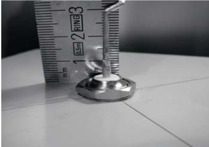
Figure 4.27: La première boucle devrait commencer à 3,0 centimètres de la surface de la plaque.
