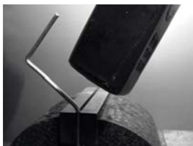
Figure 4.17: Plier le fil en forme de « Z ».
