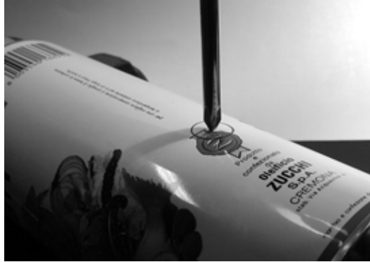
Figure 4.36: Marquez le trou avant de percer.
