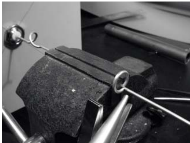
Figure 4.29: Répétez la même procédure «d'étirement» pour les boucles restantes.
