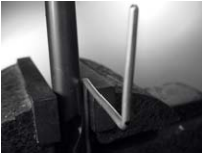
Figure 4.18: Courber le fil autour de la perceuse pour faire une boucle.
