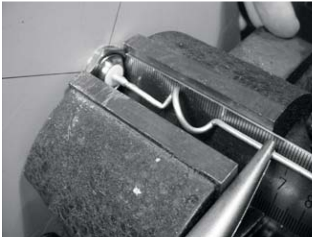
Figure 4.28: Étirer les boucles. Procédez en douceur et essayer de ne pas érafler la surface du fil avec les pinces.
