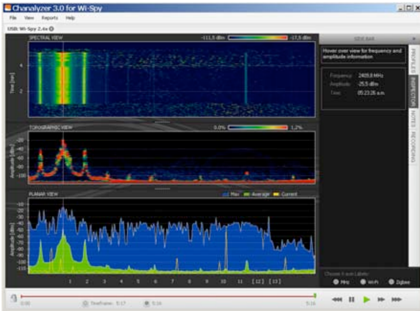
Figure 8.9 : Le motif distinctif en pic à gauche du graphe est causé par un transmetteur de télévision puissant de 2.4 GHz.
