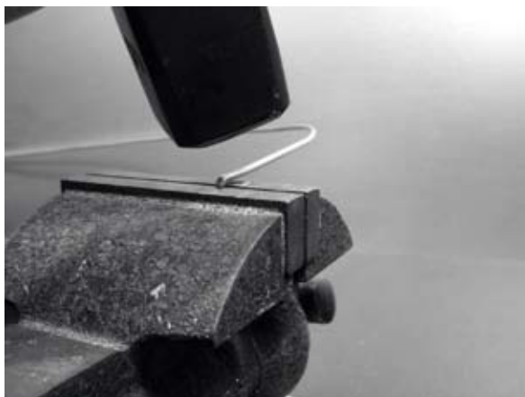
Figure 4.16: Frapper doucement sur le fil pour faire une courbe fermée.
