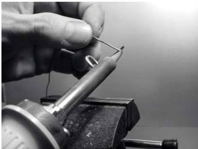
Figure 4.26: Ajouter un peu d'étain à l'extrémité du fil avant de le souder.
