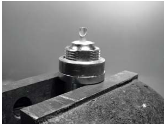
Figure 4.24: Ajouter un tuyau de cuivre comme entretoise aide à obtenir une impédance d'antenne de 50 Ohms.
