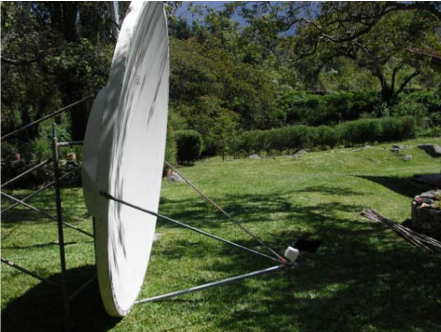
Figure 11.29: Réflecteur d'alimentation offset de 2,4 m avec une antenne de 12 dBi à son foyer, tourné 14^\circ vers le bas. L'élévation réelle est de 8^\circ vers le haut.
